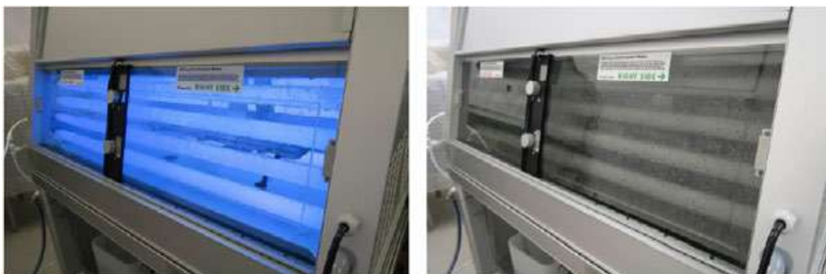
Obr. 9 Pohľad na prístroj QUV (vľavo UV perióda, vpravo vlhkostná perióda, foto: L.Bosák)
