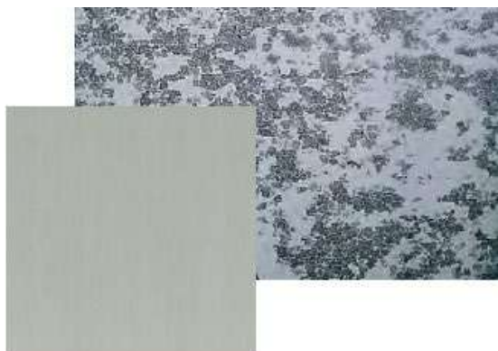
Obr. č 1: tvorba patiny na povrchu materiálu RHEINZINK
