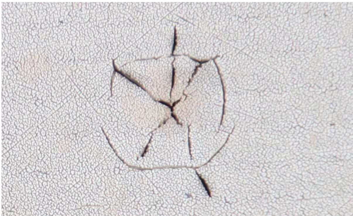
Obr. č. 1 - díra po kroupě v syntetické fólii staré 4 roky
