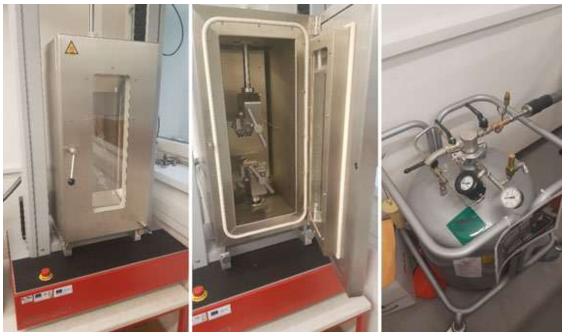
Obr. 13 Trhací prístroj M500-25 CT s klimakomorou TH2700 (vľavo, stred); Nádoba na kvapalný dusík Cryotherm 50L (vpravo)
