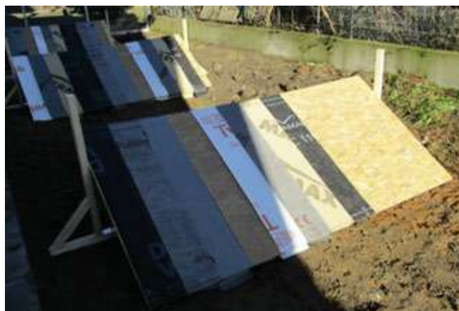
Obr. č.3. Zkušební vzorky vystavené působení vlivům vnějšího prostředí (přirozené stárnutí). Zdroj: [3].
