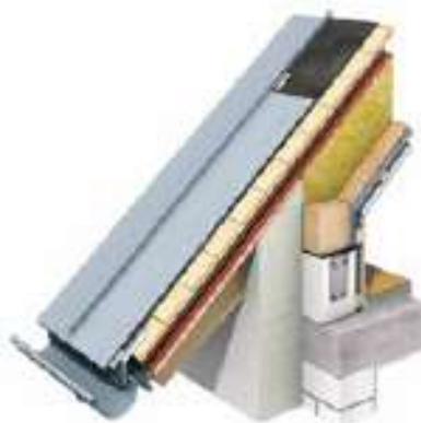
obr. č. 21: dvojité stojatá drážka s aplikáciou štruktúrovanej rohože
